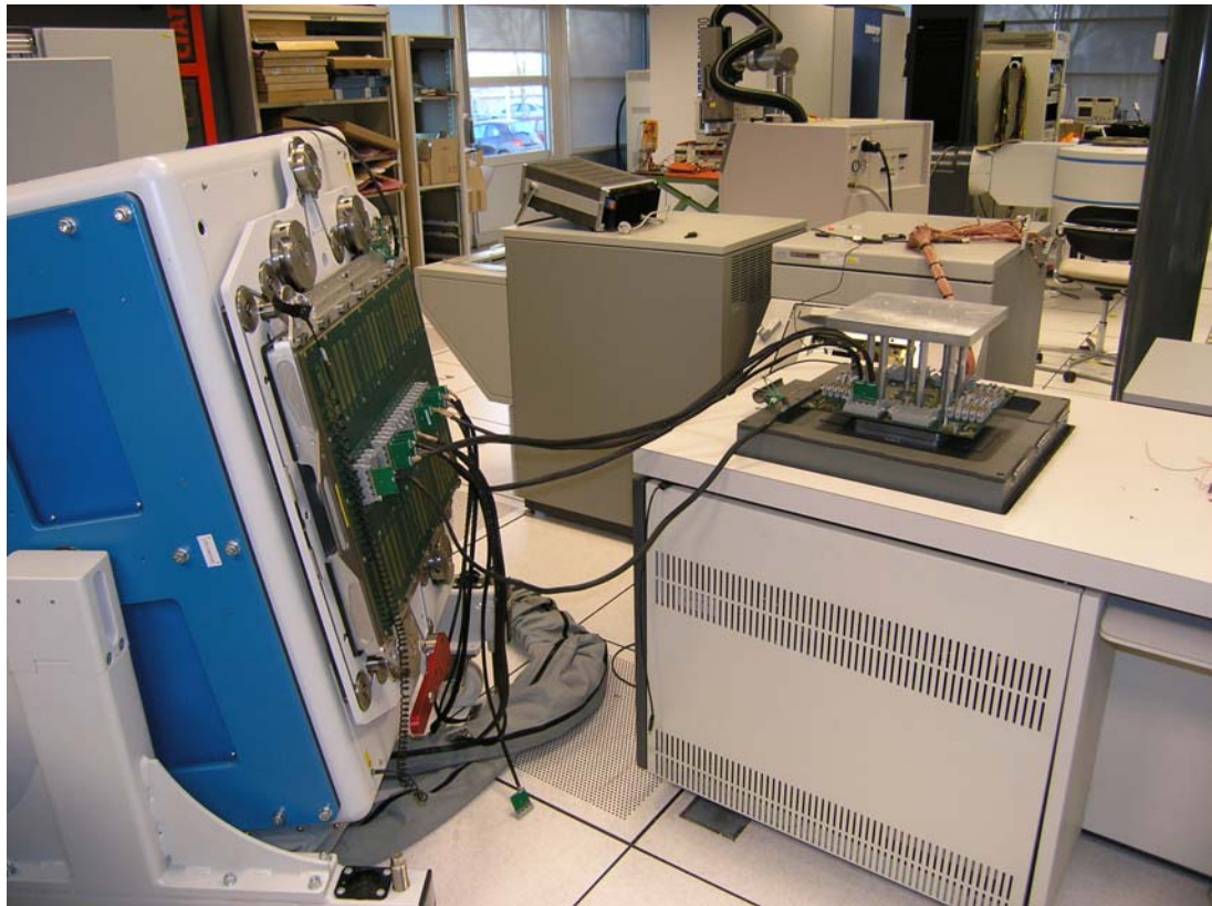
Figure 8 –Test d'un composant dans un contexte spatial. Le testeur (en bleu à gauche) est un Sapphire, de Credence.
