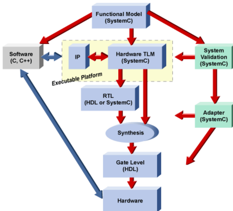
Figure 1. Le flot de conception d'un système complet (H/S) (image appartenant à Forte Design Systems)
